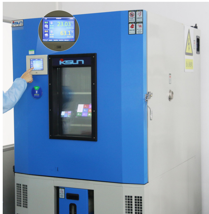
图 4-7 高低温老化测试图
